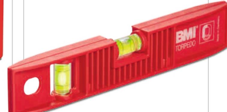
Das Profigerät mit definierter Genauigkeit, in Normlage Messgenauigkeit 1,0 mm/m, glasfaserverstärkter ABS-Kunststoff, gut sichtbare Rundlibellen für Horizontal- und Vertikalmessung, 25 cm lang, optional mit
