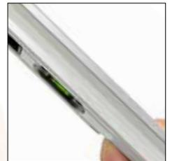
rillengefräste Messfläche mit V-Nut
